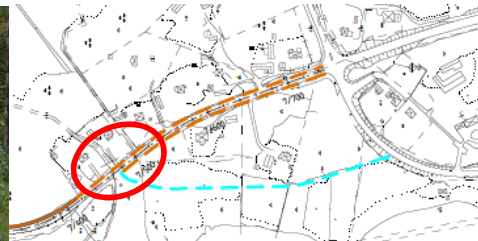
Bild 6) Längdmätning 7/500, För separat gång- och cykelväg som leds vidare över väg 604 (enligt cyanfärgad streckad markering) behöver en säker passage över väg 604 ses över. Förslagsvis sker passagen enligt röd markering på bilden där siktförhållanden är goda.
