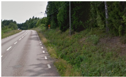
Bild 4) Längdmätning 5/300 – 6/700, Separat gång- och cykelväg utmed väg 604 med undantag för sträckan 6/400 – 6/600 där kantstöd föreslås på grund av bebyggelse nära vägen.
