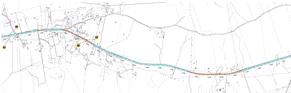
Bild 2) Längdmätning 1/800 – 4/050, Separat gång- och cykelväg varvas med gång- och cykelväg med kantstöd pga. varierade terrängförhållanden och intilliggande bebyggelse utmed sträckan. Befintlig väg/stig genom skogspartierna som syns i ritningens överkant undviks på grund av att tillgänglighets-, framkomlighets- och/eller trygghetsaspekten inte kan uppnås.
