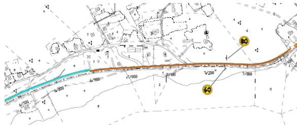
Bild 4) Längdmätning 5/300 – 6/700, Separat gång- och cykelväg utmed väg 604 med undantag för sträckan 6/400 – 6/600 där kantstöd föreslås på grund av bebyggelse nära vägen.
